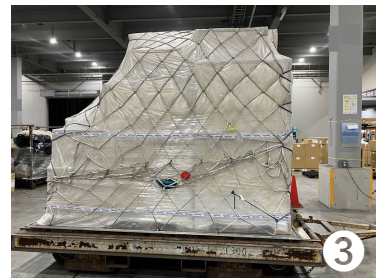
シュリンクラップやビニールシートにより防水・盗難防止対策を施し、仕上げに荷崩れ防止のためネットで固定する。
